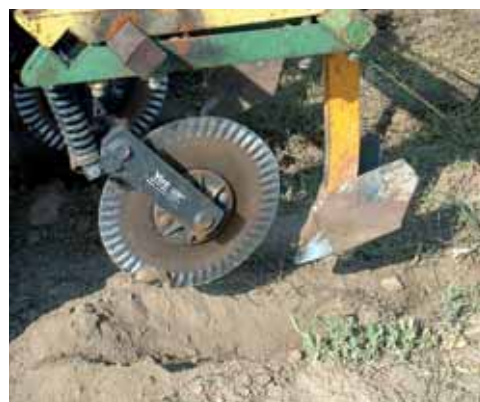
Para reformar las camas de siembra se modificó una cultivadora, a la cual se le adaptaron discos cortadores delanteros, unas "patas de mula" y contrapesos, para que corte.
